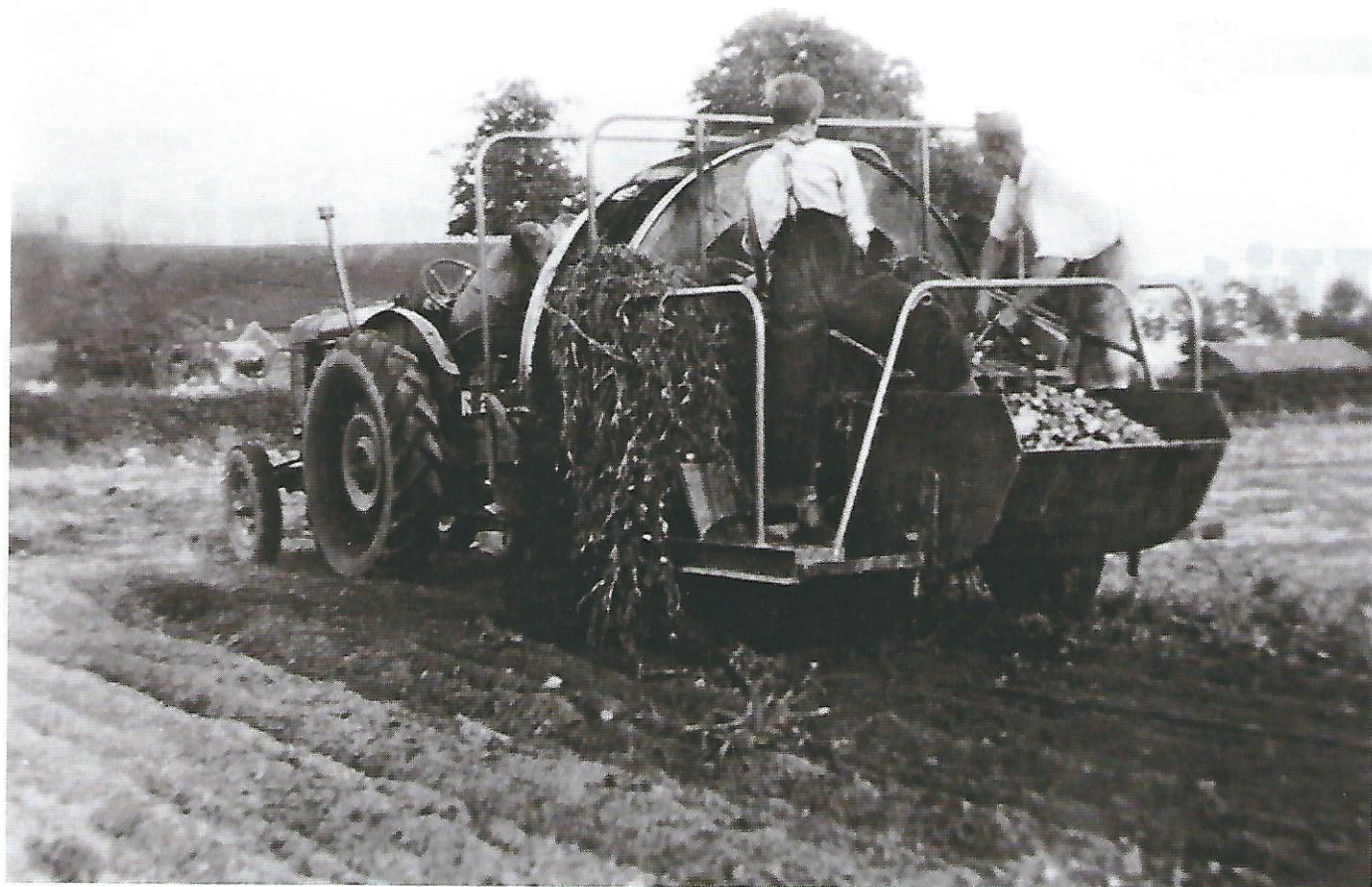
De door Vicon gebouwde machine in bedrijf in 1950, uitgerust met verzamelmak. Twee man rapen het aardappelloof.
